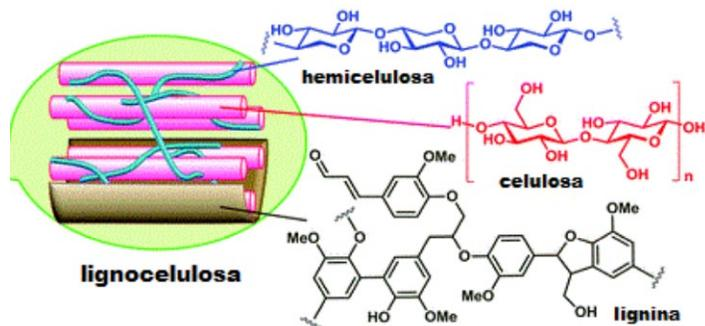
Fig. 1. Disposición de la red polimérica de biomasa lignocelulósica<sup>16</sup>
